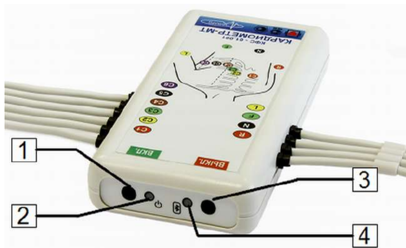
Рис. 3.4: Кардиометр. Вид сверху: 1 – кнопка включения питания; 2 – светодиод, сигнализирующий о включении питания; 3 – кнопка выключения питания; 4 – светодиод, сигнализирующий о наличии связи по Bluetooth с Android-устройством
