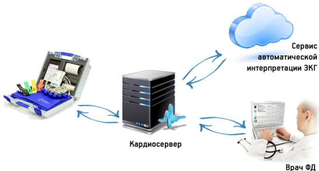
Рис. 1.2: Схема передачи ЭКГ
